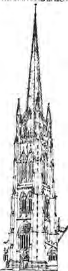
G ОТЬ УГЛОВЫХЪ БАШЕНОКЪ КЪ ПИРАМИДАЛЬНОМУ ШПИЦУ ПЕРЕКИНУТЫ УГОРНЫЯ АРКИ (XIVв)
