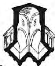
И Усиленная система кладки купола въ равнинѣ (420 г.).
