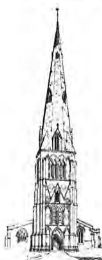
A УГЛЫ МЕЖДУ КВАДРАТНОЮ ВЪ ПЛАНѢ БАШНЕЮ И ВОСЬМИГРАННЫМЪ ШПИЦЕМЪ ЗАПОЛНЕННЫ ПИРАМИДАМИ (XIIIв)
