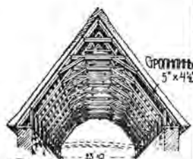
A КРУТАЯ ДВУСКОТНАЯ КРЫША • КЪ ТАКИМЪ СТРОПИЛАМЪ ЧАСТО ПОДШИВАЮТСЯ МНОГОУГОЛЬНЫМЪ ДОСЧАТЫМЪ ПОТОЛОКОМЪ
