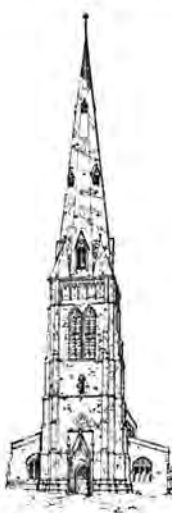
A УГЛЫ МЕЖДУ КВАДРАТНОЮ ВЪ ПЛАНѢ БАШНЕЮ И ВОСЬМИГРАННЫМЪ ШПИЦЕМЪ ЗАПОЛНЕННЫ ПИРАМИДАМИ (XIIIв)
