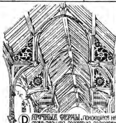
A КРУТАЯ ДВУСКОТНАЯ КРЫША • КЪ ТАКИМЪ СТРОПИЛАМЪ ЧАСТО ПОДШИВАЮТСЯ МНОГОУГОЛЬНЫМЪ ДОСЧАТЫМЪ ПОТОЛОКОМЪ
