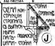
G ОДНОСКОТНАЯ КРЫША •
