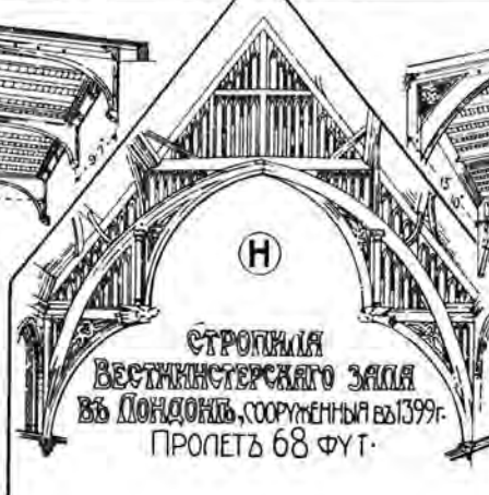
D АРОЧНЫЯ ФЕРМЫ, ПОКОЮЩАСЯ НА ДЕРЕВ. ПАЛЬЦАХЪ, ПОДПЕРТЫХЪ ПОДКОСНИ.
