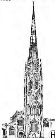
G ОТЬ УГЛОВЫХЪ БАШЕНОКЪ КЪ ПИРАМИДАЛЬНОМУ ШПИЦУ ПЕРЕКИНУТЫ УГОРНЫЯ АРКИ (XIVв)
